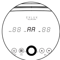
기기는 장시간 사용 시 과열 방지를 위해 'AA' 메시지를 출력합니다. 1시간 이상 충분히 식혀주세요.
